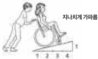
이 경사로는 이동거리가 높이의 4배이다. 아주 짧은 거리가 아니라면, 대부분 사람들이 사용하기에는 지나치게 가파르다.
