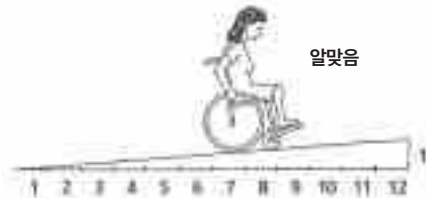
대부분의 경사로는 이동거리가 높이의 8~12배이다. 이 경사로는 12배이다. 이 정도의 경사는 휠체어 사용자도 쉽게 이용할 수 있다.
